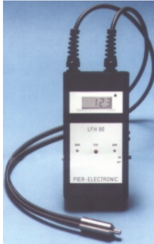
Bild 8, IR-Photometer zur direkten Feuchtemessung an Baustoffen, mit normaler Oberflächensonde
