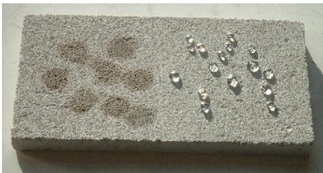
Gasbetonstein, rechts hydrophobiert, links ohne Hydrophobierung. Deutlich sind, auf der linken, nicht behandelten Hälfte, die dunkelen nassen Flecken aufgesaugter Wasser-Tropfen zu erkennen. Auf der hydrophobierten rechten Steinhälfte spiegelt sich das Licht in den abperlenden Wassertropfen.
