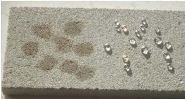
Abb. 1 Wassertropfen auf einer Steinoberfläche linke ohne, rechts mit Lotupor-Imprägnierung
