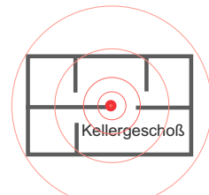
Bild 9 Hausgrundriss, Funk-Sender (roter Punkt) und Ausbreitung der Funkwellen
